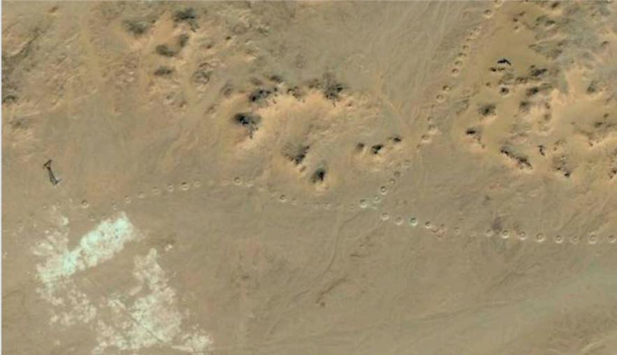
Figure 6. Image satellitaire du tracé des bouches des puits verticaux d'une foggara dans la zone du pilote.
