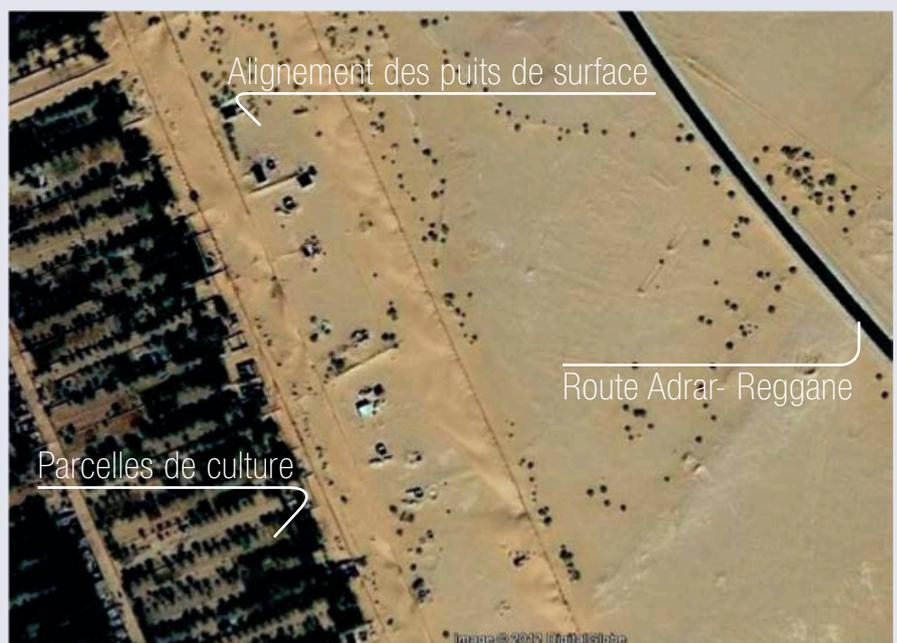
Figure 5. Localisation d'une batterie de puits de surface parallèlement à la périphérie Est de l'oasis.
