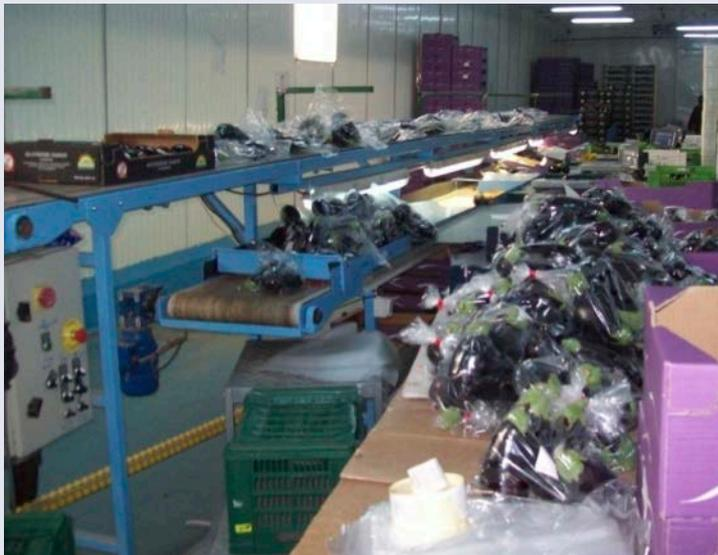
Figure 118. Un équipement de pesage et d'étiquetage des productions destinées à l'exportation.
