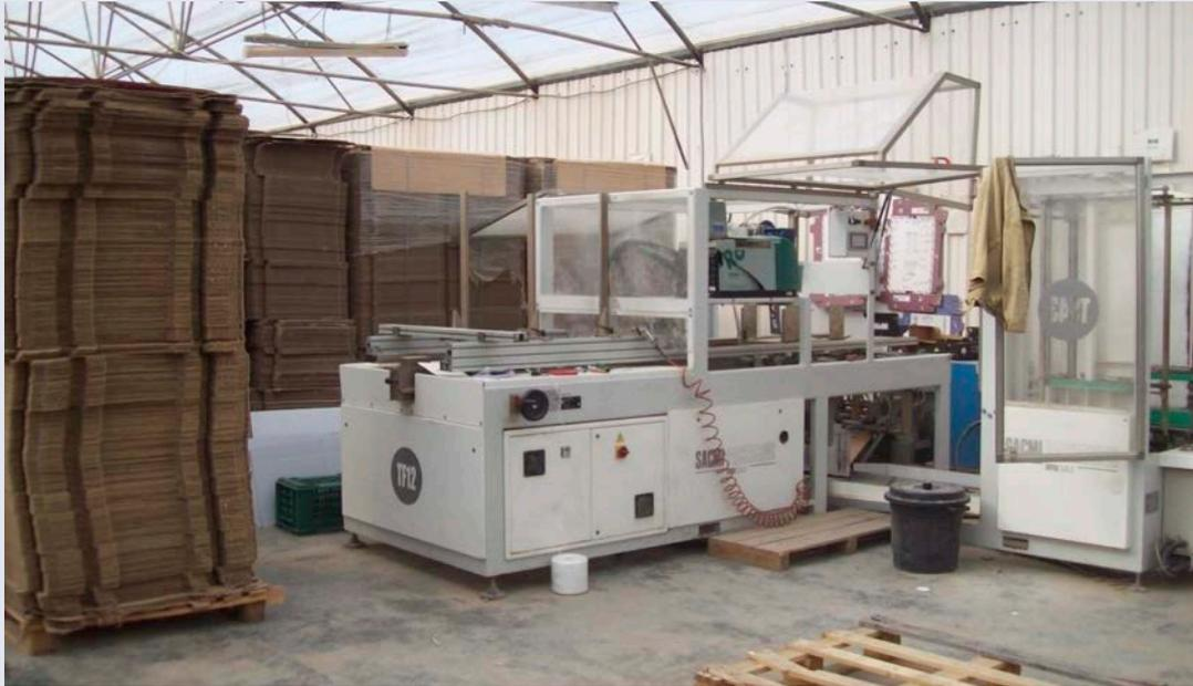
Figure 117. Un équipement pour la fabrication et l'impression des emballages en carton pour le conditionnement des productions destinées à l'exportation.
